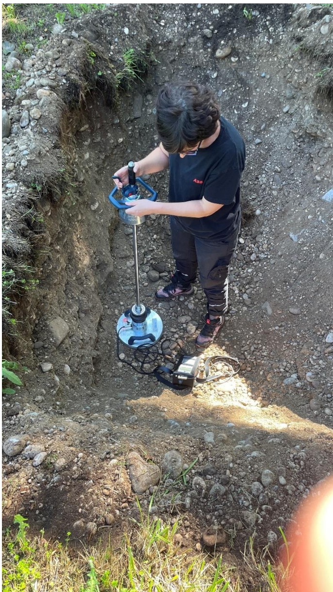
Slika 10: Meritev dinamičnega deformacijskega modula ( E_{vd} ) v SR 1
