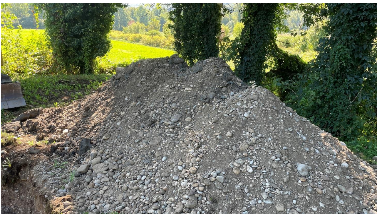
Slika 8: Dobro nosilen zapeščen savski prod iz nasipa (SR-1)
